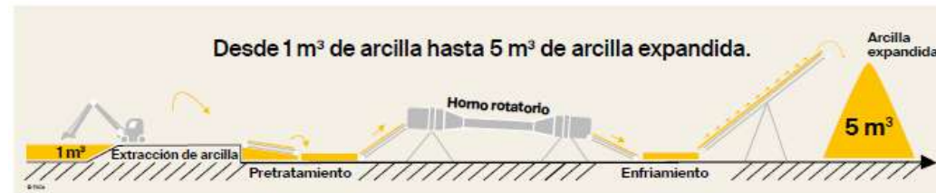
Proceso productivo de la arcilla expandida
